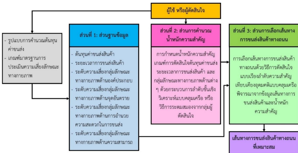
รูปที่ 2 โครงสร้างของระบบสนับสนุนการตัดสินใจที่เสนอ
