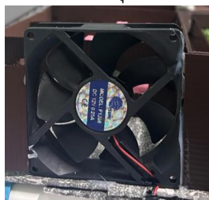
รูปภาพที่ 6 พัดลมระบายอากาศ
