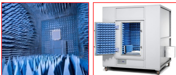
รูปที่ 1 ห้องทดสอบความเข้ากันได้ทางแม่เหล็กไฟฟ้า ขนาดใหญ่และขนาดเล็ก
