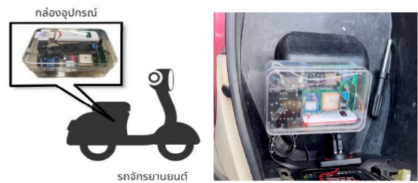
รูปที่ 3 รูปแบบของกล่องวงจร เพื่อนำไปใช้งานร่วมกับรถจักรยานยนต์
