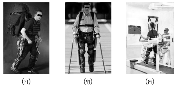
รูปที่ 1 ตัวอย่าง Lower Limb Exoskeleton ที่มีการพัฒนา (ก) BLEEX [2] (ข) ReWalk [2] (ค) Lokomat [2]
