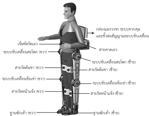
รูปที่ 3 ชุดโครงหุ่นยนต์ที่ใช้ในงานวิจัยนี้
