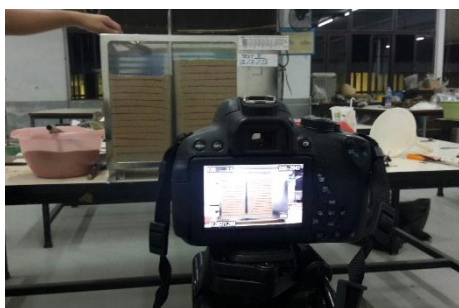
รูปที่ 5 ติดตั้งกล้องถ่ายรูปเพื่อบันทึกค่าการเคลื่อนตัว วิธีทดลองแบบจำลองเข้มน้ำ
