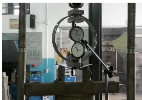
รูปที่ 3 การทดสอบเพื่อหา Elastic Modulus ของกำแพงจำลอง
