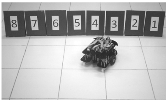
รูปที่ 13 หุ่นยนต์หยุดและถอยหลังแล้วเคลื่อนที่ออกทางขวา
