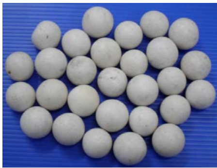
รูปที่ 2 เซรามิกส์เม็ดกลมชนิดอะลูมินา-คอร์ดีไรท์ (Al-Co) ที่เลือกใช้เป็นวัสดุพรุนชนิดเม็ดกลมอัดแน่น
