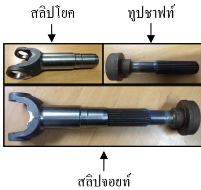
รูปที่ 1 ชิ้นส่วนและการประกอบสลิปจอยท์
