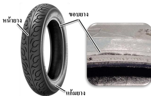
รูปที่ 1 หน้ายาง, ขอบยาง และปัญหาการรอยแตกบริเวณขอบยาง
