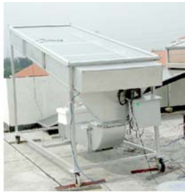
รูปที่ 7 แผงรับพลังงานแสงอาทิตย์แบบผลิตไฟฟ้าร่วมกับอากาศร้อน
