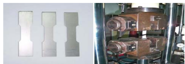
ก) ชิ้นทดสอบสำหรับทดสอบแรงดึง ข) หัวจับทำการดึงขึ้นทดสอบ รูปที่ 4 ชิ้นทดสอบสำหรับทดสอบแรงดึงและการดึงขึ้นทดสอบ
