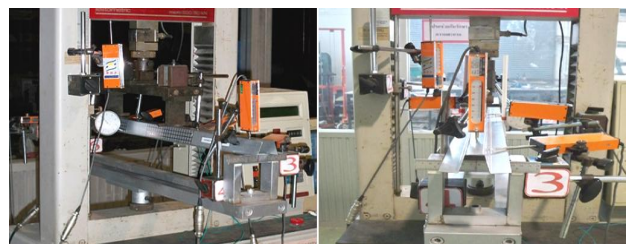
รูปที่ 8 ติดตั้งเครื่องมือวัดกลางคานวัดการเคลื่อนตัวและตำแหน่งที่มีการเสียรูปของคานเหล็กขึ้นรูปเย็นขนาดรับแรงกดัด
