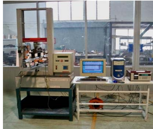
รูปที่ 6 เครื่องกดยี่ห้อ Testometric และเครื่องมือ อุปกรณ์ที่ใช้ทดสอบ
