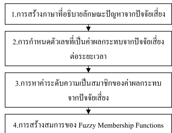
รูปที่ 1 ขั้นตอนการวิเคราะห์ผลกระทบของปัจจัยเสี่ยงในเชิงตัวเลข ด้วยวิธี Modified Horizontal Approach
