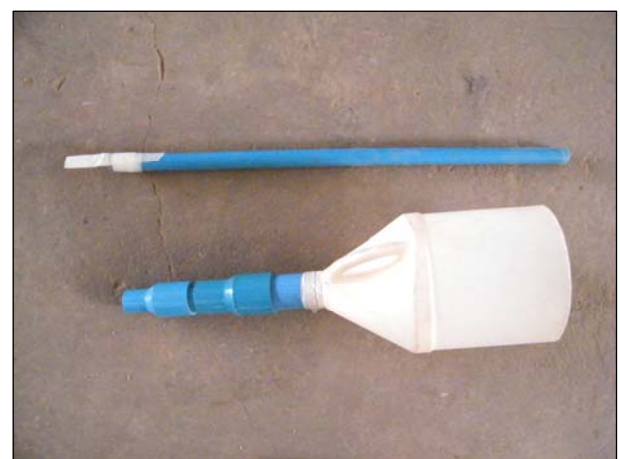
รูปที่ 4 กรวยและท่อพีวีซีที่ใช้ในการ โรยทราย
