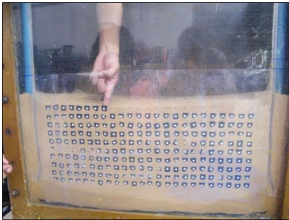
รูปที่ 5 การติดตั้งหมุดสังเกตการณ์
