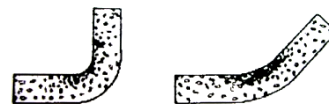
รูปที่ 2 การกระจายตัวขนาดเกรนของโลหะในการงอ
