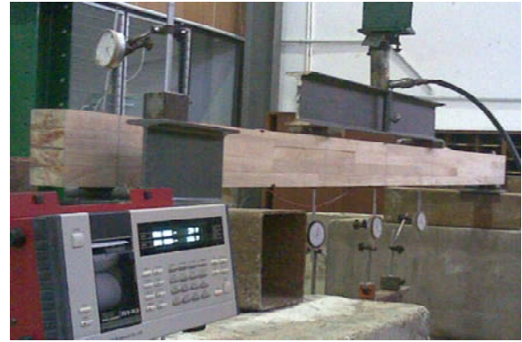
รูปที่ 6 การทดสอบคานภายใต้การดัดแบบแรงกระทำ 4 จุด
