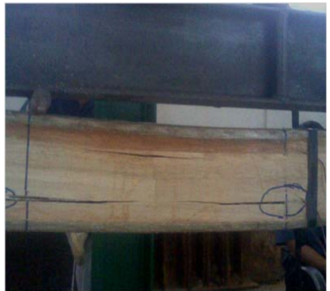
รูปที่ 13 รอยแตกร้าวและการพืดของคาน
