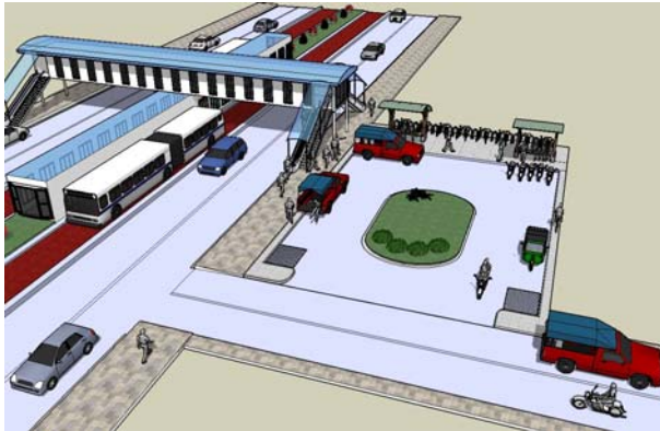
รูปที่ 2 ตัวอย่างการออกแบบสถานีบีอาร์ทีที่เชื่อมต่อกับสถานีรถโดยสารสาธารณะขนาดเล็ก
