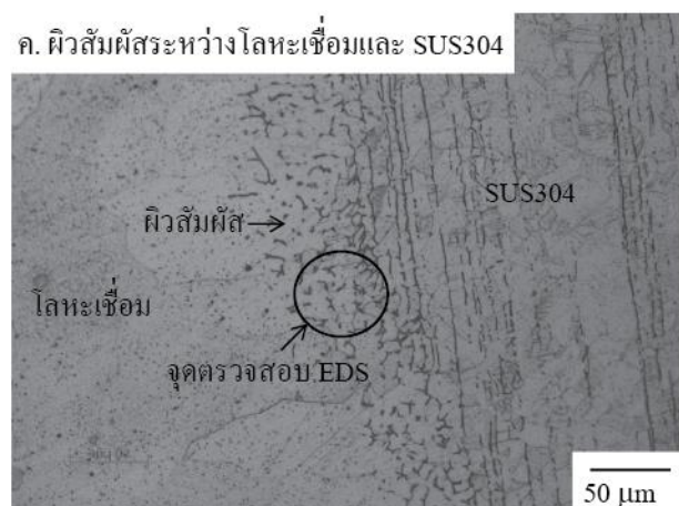
รูปที่ 7 โครงสร้างจุลภาคของรอยต่อตัวที่ SS400/SUS304 ที่เชื่อมด้วยกระแส 160 แอมแปร์
