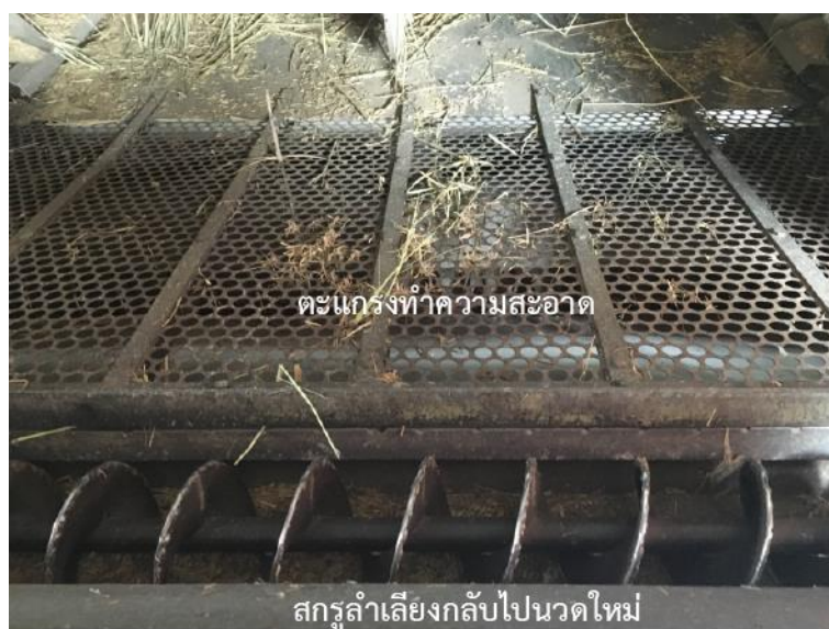
รูปที่ 1 สกรูลำเลียงสำหรับนำเมล็ดข้าวเปลือกกลับมานวดใหม่ในรถเกี่ยวและนวดข้าว
