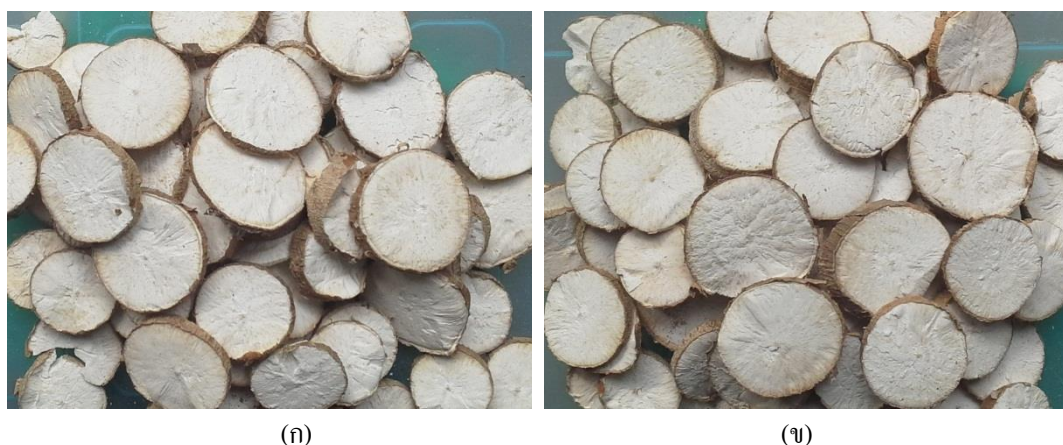
รูปที่ 6 ลักษณะมันสำปะหลังเส้นอบแห้งจากการทดลอง (ก) Solar & Biomass Dryer (ข) Solar Traditional Dryer
