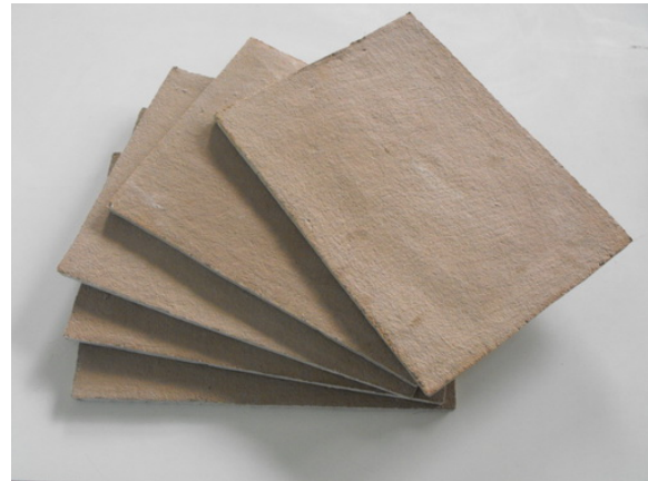
รูปที่ 1 แผ่นยิปซัมผสมเศษฝุ่นฝ้ายขนาด 300 x 400 x 9 มม.
