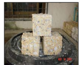
(ก) บ่มในกรดซัลฟริก ( \text{H}_2\text{SO}_4 ) (ข) แช่ในกรดอะซิติก ( \text{CH}_3\text{COOH} ) รูปที่ 4 ตัวอย่างคอนกรีตที่ผ่านการแช่ในกรด
