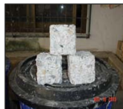
(ก) บ่มในกรดซัลฟริก ( \text{H}_2\text{SO}_4 ) (ข) แช่ในกรดอะซิติก ( \text{CH}_3\text{COOH} ) รูปที่ 4 ตัวอย่างคอนกรีตที่ผ่านการแช่ในกรด
