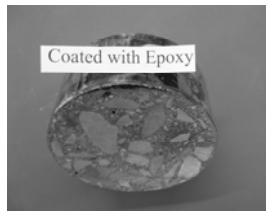
รูปที่ 1 การเตรียมตัวอย่างคอนกรีตในการทดสอบ RCPT
