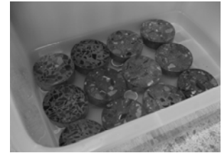
รูปที่ 3 การเตรียมตัวอย่างคอนกรีตสำหรับการทดสอบการแทรกซึมของคลอไรด์โดยวิธีการแช่แบบจุ่มทั้งหมด
