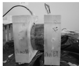
รูปที่ 2 การทดสอบ RCPT ตามมาตรฐาน ASTM C 1202
