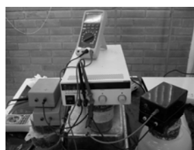
รูปที่ 2 การทดสอบ RCPT ตามมาตรฐาน ASTM C 1202
