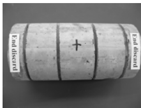
รูปที่ 1 การเตรียมตัวอย่างคอนกรีตในการทดสอบ RCPT
