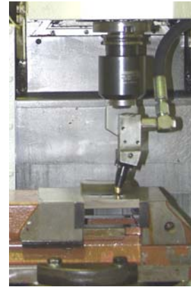
รูปที่ 6 กระบวนการรีดผิวละเอียดบนเครื่องกัด
