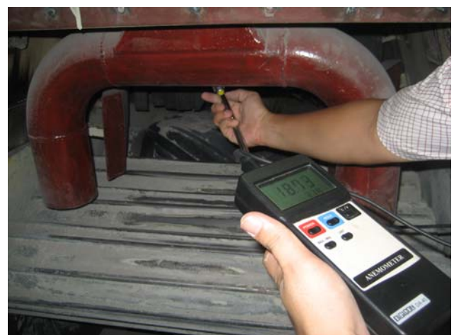
ภาพที่ 6 ระบบต้นแบบที่ดำเนินการติดตั้งเรียบร้อยแล้ว (บน) และ (ล่าง) การใช้อุปกรณ์ตรวจสอบวัดความเร็วและปริมาณลม
