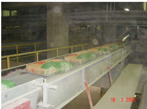
ภาพที่ 3 สายพานลำเลียงถุงปูนที่มีการปนเปื้อนก่อนการติดตั้งระบบดักฝุ่นต้นแบบ
