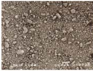
อนุภาคของแร่ดินเบาทำลึงขยาย 100 เท่า
