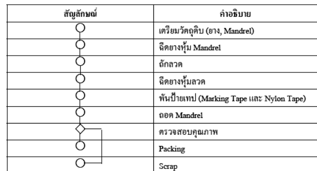
รูปที่ 3 Outline Process Chart ของ กระบวนการผลิต
