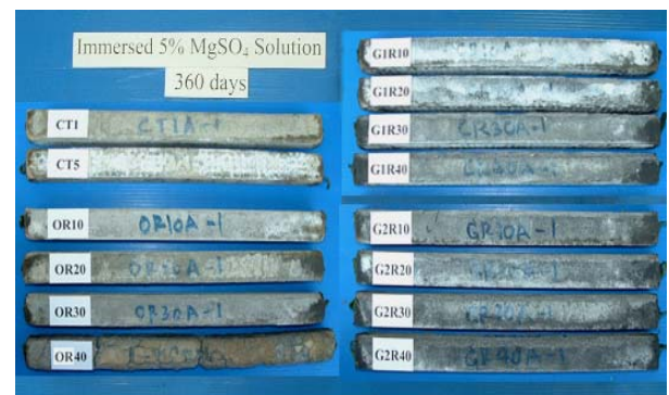
รูปที่ 7 ความเสียหายของมอร์ตาร์ที่แช่ในสารละลายแมกนีเซียมซัลเฟตที่อายุ 360 วัน
