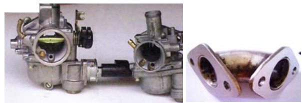
รูปที่ 8 คาร์บูเรเตอร์และท่อไอดี
