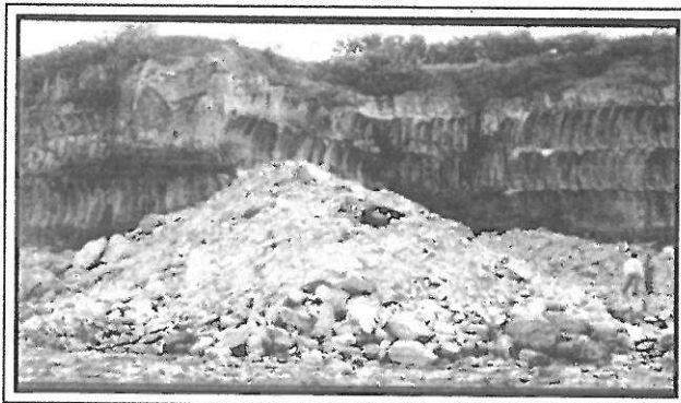
(ข) กองแร่แอนไฮไดรต์ที่คัดออกเพื่อนำไปทิ้ง
