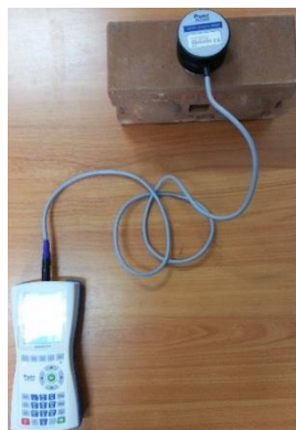
รูปที่ 6 การทดสอบค่าการนำความร้อน (Thermal conductivity) ของอิฐบล็อกประสาน
