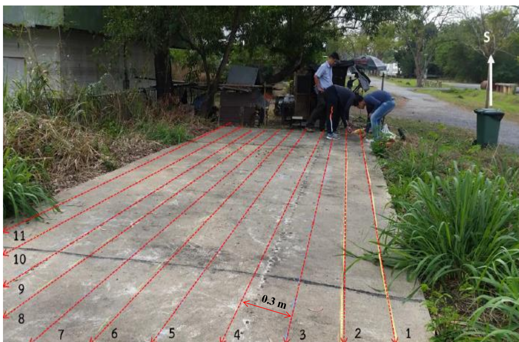
รูปที่ 8 แนวการสำรวจและทิศทางการลากของสายอากาศความถี่ 400 MHz
