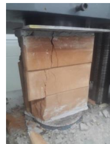
การวิบัติของตัวอย่างปริซึมอิฐก่อ
