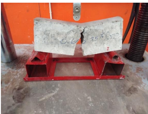
รูปที่ 9 คานตัวอย่างขนาดกลางหลังการวิบัติ
