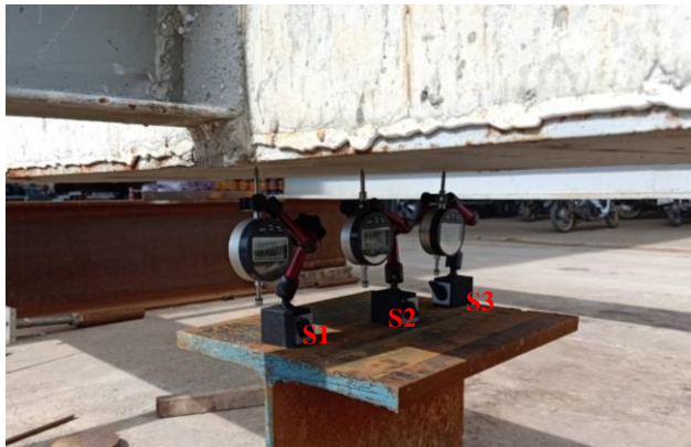
(ก) ติดตั้ง Digital dial gauge และอ่านค่าเริ่มต้น
