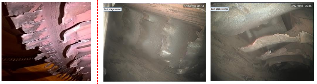
รูปที่ 10 ใบพัดคอมเพรสเซอร์แตกหักเสียหาย
