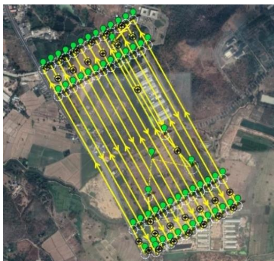
รูปที่ 5 เส้นทางการบินของอากาศยานไร้คนขับที่บินบันทึกภาพภายในงานวิจัย
