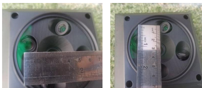
รูปที่ 7 การวัดระยะห่างจากกล้องกลางไปยังกล้องอื่น ๆ บนระบบกล้องหลายหัว
