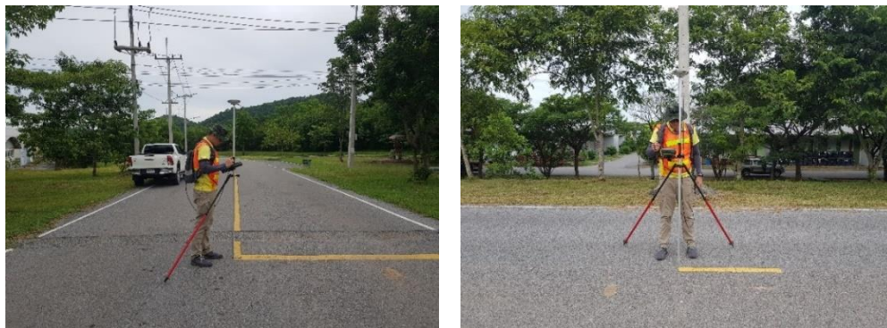
รูปที่ 6 ตัวอย่างการสำรวจรังวัดค่าพิกัดภาคพื้นดินของจุดบังคับภาพถ่ายทางอากาศที่อาศัยเป็นธรรมชาติ (Post-marking GCP)
