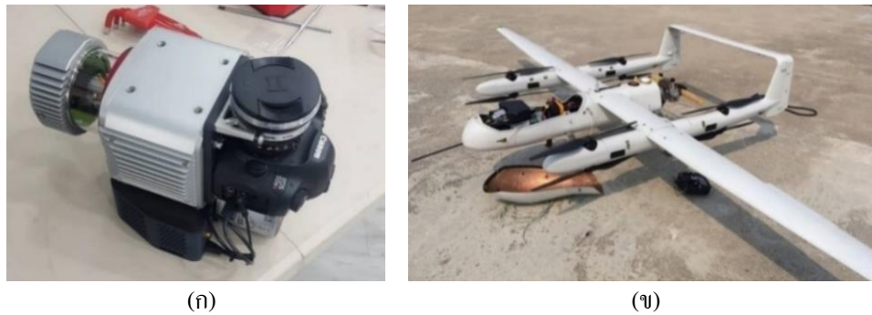
รูปที่ 1 (ก) เครื่องเลเซอร์สแกนเนอร์ รุ่น LiDAR Swiss Micro VUX CE และกล้องถ่ายภาพดิจิทัล Canon EOS 5DSR (ข) การติดตั้งอุปกรณ์สำรวจเข้ากับอากาศยานไร้คนขับรุ่น SUD VTIOI-60
