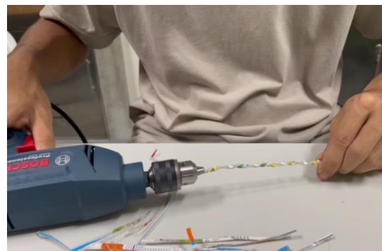
รูปที่ 5 การเตรียมตัวอย่างเส้นใยจากขยะกล่องเครื่องดื่ม
