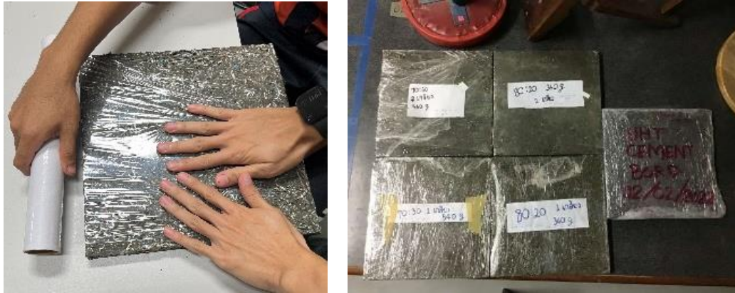
รูปที่ 8 การบ่มตัวอย่างแผ่นที่จะดำเนินการทดสอบ
