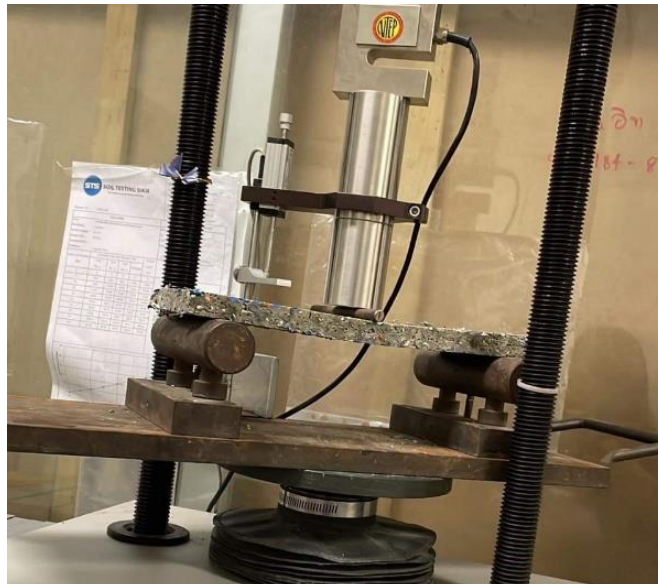
รูปที่ 9 การติดตั้งแผ่นตัวอย่างสำหรับทดสอบมอดูลัสแตกหัก (MOR) แผ่นซีเมนต์บอร์ด
