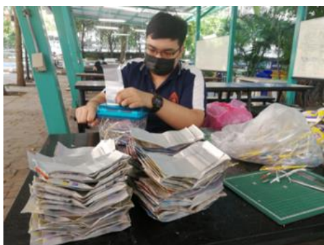
รูปที่ 5 การเตรียมตัวอย่างเส้นใยจากขยะกล่องเครื่องดื่ม
