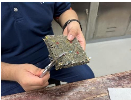
รูปที่ 11 การวัดแผ่นหาค่าการพองตัวของแผ่นซีเมนต์บอร์ด (Ts)
