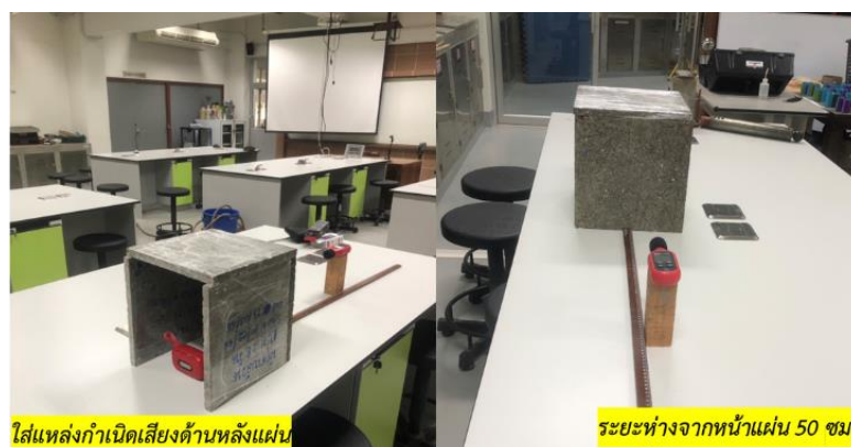
รูปที่ 13 แสดงการทดสอบการดูดซับเสียง
