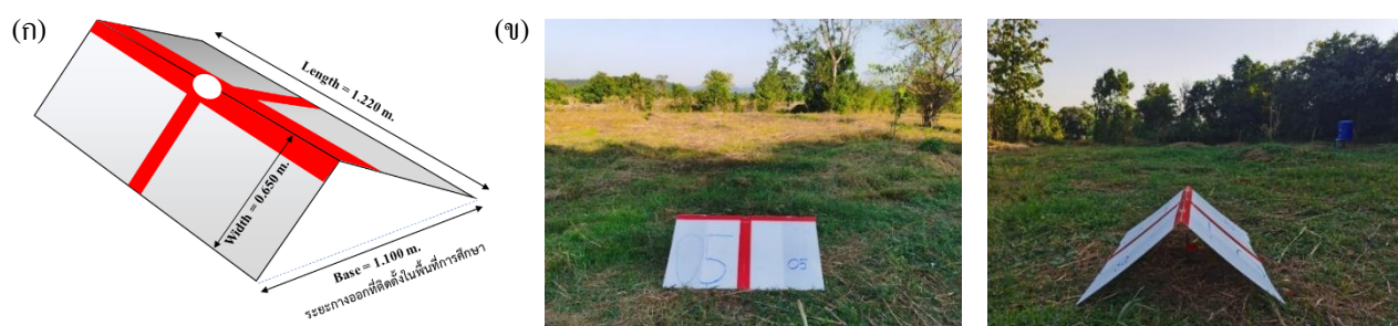
รูปที่ 3 (ก) ตัวอย่างเป้าหลังคาสำหรับไลดาร์ที่ได้ทำการออกแบบ (ข) เป้าหลังคาที่ติดตั้งในพื้นที่การศึกษา
