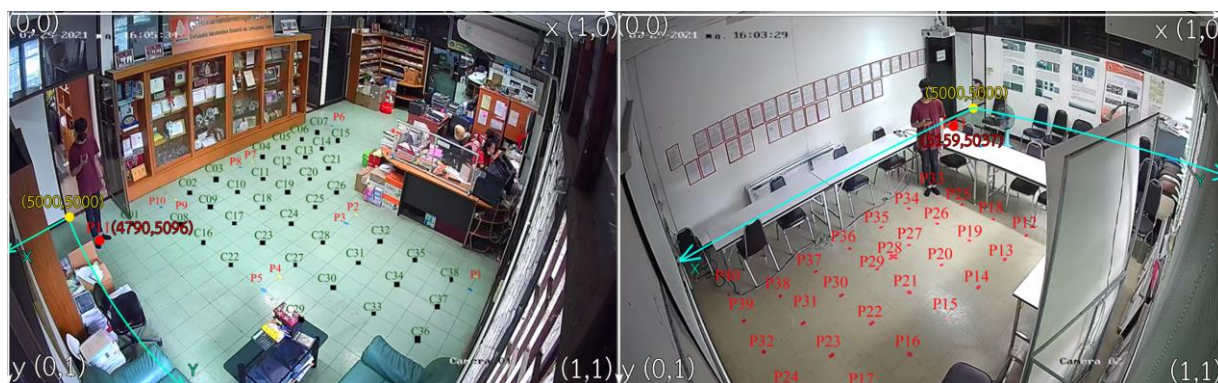
รูปที่ 8 ภาพถ่ายจากกล้อง CCTV ที่มีการร่างระบบแกนของระบบพิกัดห้องซึ่งมีจุดศูนย์กลางที่กำหนดขึ้นเองโดยกำหนดที่มุมของวงกบประตูให้มีค่าพิกัดจุดสี่เหลี่ยม และมีตำแหน่งมุมบังคับภาพถ่ายและมุมตรวจสอบกระจายอยู่ทั่วทั้งห้อง (ทั้งนี้ห้องทั้งสองนี้มีใช้ระบบพิกัดร่วมกัน)
