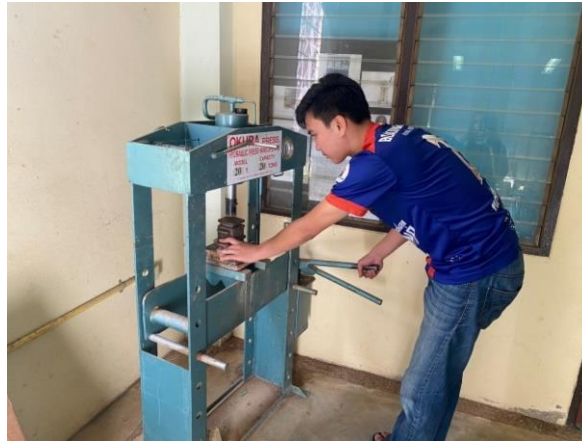
รูปที่ 3 การอัดขึ้นรูปบล็อกประสานโดยใช้เครื่องอัดไฮดรอลิกแบบมือโยก
