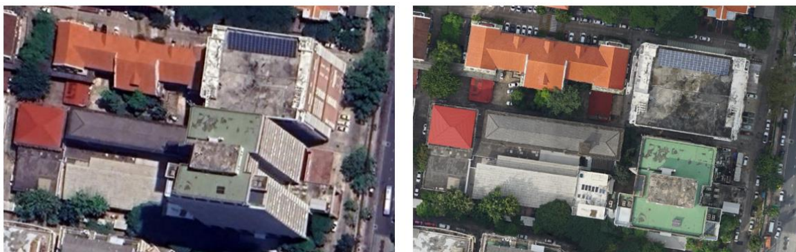
รูปที่ 2 ภาพจากดาวเทียม Google Earth (ซ้าย) และภาพออร์โธจริงจากอากาศยานไร้คนขับ (ขวา)
