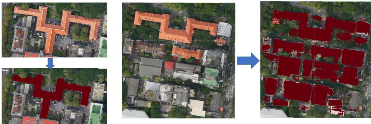
รูปที่ 7 ตัวอย่างการสกัดรอยพิมพ์ฐานอาคารแบบจุด กรณีสกัดจุดเดียว (ซ้าย) กรณีสกัดหลายจุด (ขวา)
