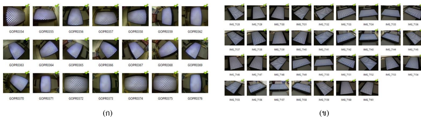
รูปที่ 4 ภาพถ่ายการวัดสอบด้วย (ก) กล้องดิจิทัลแบบแอคชั่น และ (ข) กล้องถ่ายภาพแบบคอมแพค
