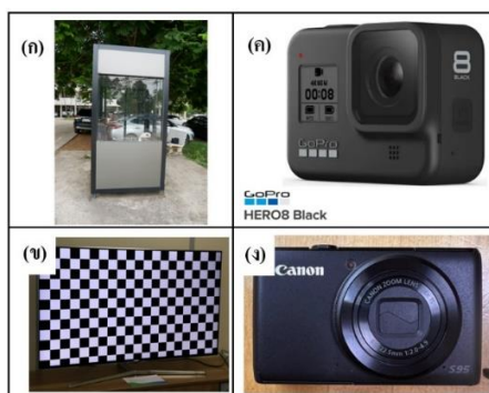
รูปที่ 1 (ก) อาคารป้อมยามรักษาความปลอดภัยที่มีรูปทรงสี่เหลี่ยมสำหรับการใช้ในการศึกษา (ข) แผ่นวัดสอบที่สร้างขึ้นจากจอ LED (ค) กล้องถ่ายภาพแบบแอคชั่นรุ่น GoPro 8 Hero Black และ (ง) กล้องถ่ายภาพแบบคอมแพคชั่นรุ่น Canon PowerShot S95
