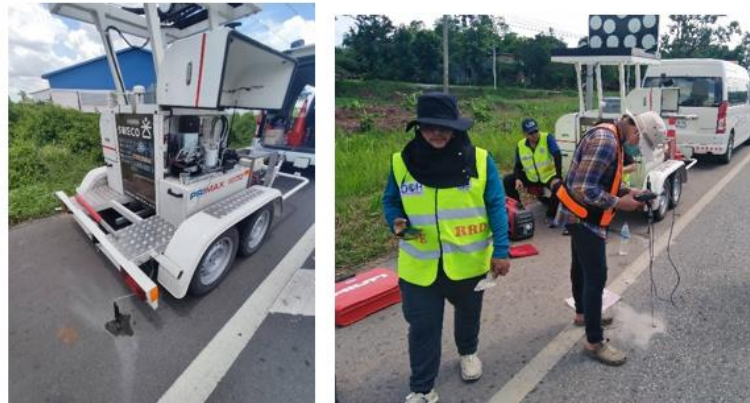
รูปที่ 6 การวัดอุณหภูมิชั้นทางแอสฟัลต์คอนกรีตและการเจาะสำรวจชั้นทางเบื้องต้น
