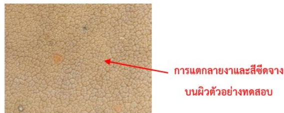
รูปที่ 11 ตัวอย่างลักษณะผิวกรวยจราจรยางธรรมชาติที่เกิดการเสื่อมสภาพ
