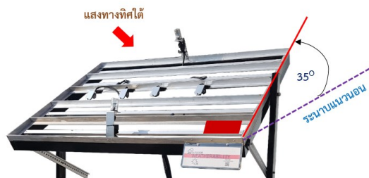
รูปที่ 10 ลักษณะการวางตัวอย่างยางทดสอบบนเครื่องมือทดสอบ
