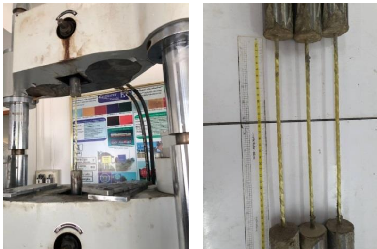
รูปที่ 1 การเตรียมตัวอย่างทดสอบของวัสดุเสริมแรงไฟเบอร์กลาส
