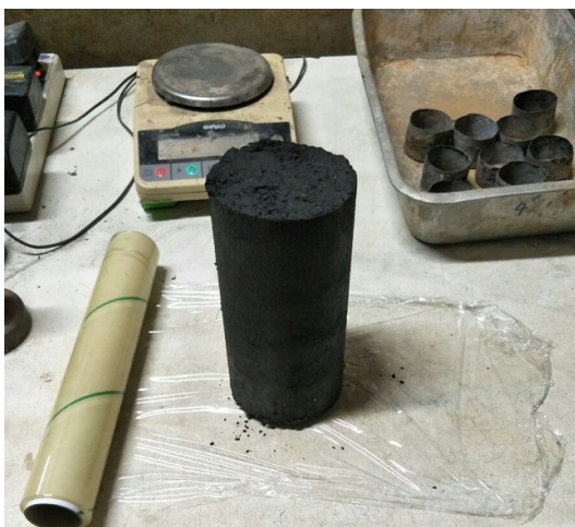
รูปที่ 5 ตัวอย่างขนาดเส้นผ่านศูนย์กลาง 10 ซม. ความสูง 20 ซม. สำหรับทดสอบกำลังอัดของถังช้อนอ้อยผสมซีเมนต์
