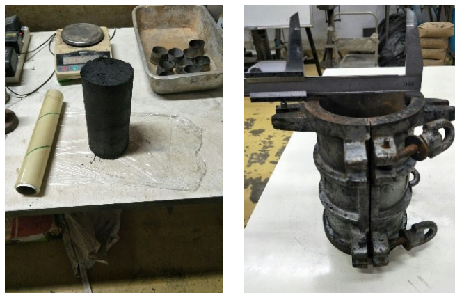
รูปที่ 2 การเตรียมตัวอย่างเถ้าขาน้อยผสมซีเมนต์ขนาดเส้นผ่านศูนย์กลาง 10 ซม. ความสูง 20 ซม. ที่ใช้ในการทดสอบ
