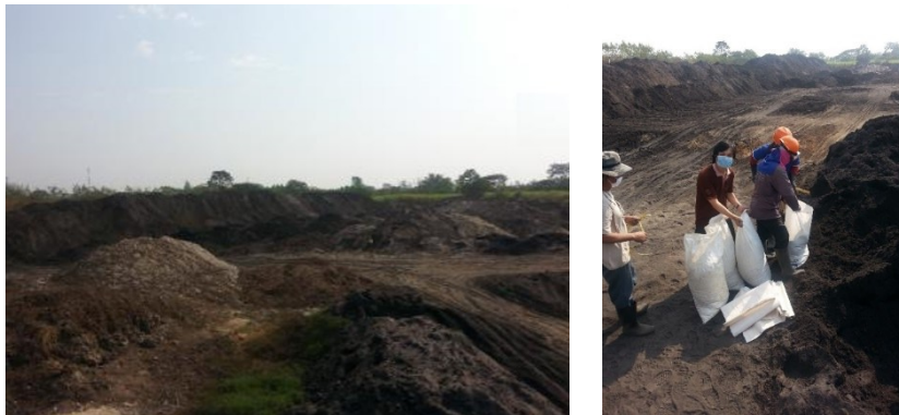
รูปที่ 1 การเก็บตัวอย่างเถ้าขาน้อยจากสถานที่กองวัสดุของโรงงานไฟฟ้าน้ำตาละขอนแก่น
