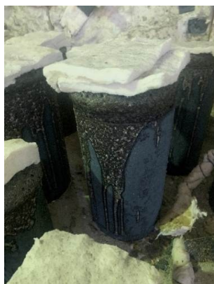
รูปที่ 10 ชิ้นงาน GFST1-S-120-B หลังสภาวะเพลิงไหม้ รูปที่ 11 ชิ้นงาน GFST1-L-120-B ขณะทดสอบกำลังรับแรงอัด
