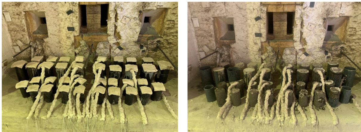
รูปที่ 6 รูปถ่ายชิ้นงานก่อนและหลังทดสอบเพลิงไหม้ ระยะเวลาทดสอบ 120 นาที
