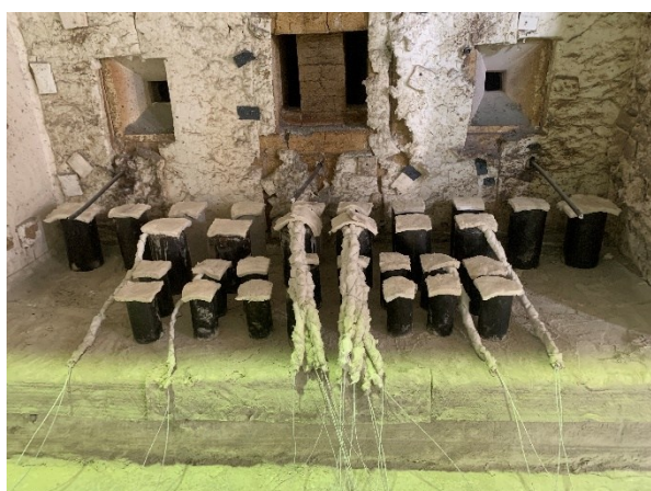
รูปที่ 5 รูปถ่ายชิ้นงานก่อนและหลังทดสอบเพลิงไหม้ ระยะเวลาทดสอบ 90 นาที
