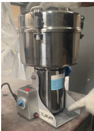
รูปที่ 1 เครื่องปั่นเถ้าแกลบที่ใช้ในงานวิจัย
