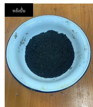
รูปที่ 2 เถ้าแกลบก่อนและหลังการปั่น
