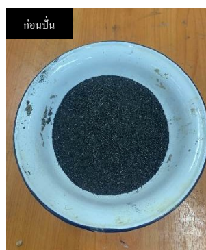
รูปที่ 2 เถ้าแกลบก่อนและหลังการปั่น
