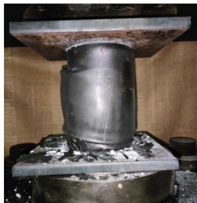
รูปที่ 10 ชิ้นงาน GFST1-S-120-B หลังสภาวะเพลิงไหม้ รูปที่ 11 ชิ้นงาน GFST1-L-120-B ขณะทดสอบกำลังรับแรงอัด
