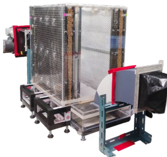
รูปที่ 2 ชุดจำลองส่วนทดลองจริงที่ใช้ในการวัดความเร็วและการกระจายตัวของอากาศก่อนเข้าสู่ห้องข้าวเปลือก
