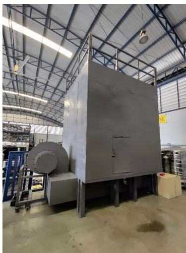
รูปที่ 8 โครงสร้างเครื่องต้นแบบนวัตกรรมลดความชื้นและเก็บรักษาข้าวเปลือก (อยู่ระหว่างการสร้างและประกอบ)
