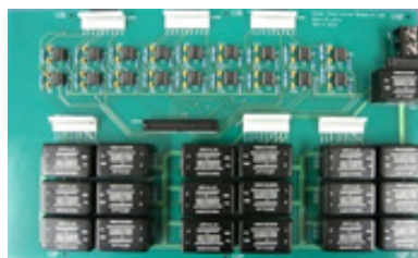
รูปที่ 16 วงจรขับเคลื่อนสวิตช์ไอจีบีที
